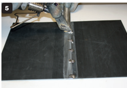
Puntsoldering van de te assembleren delen.
